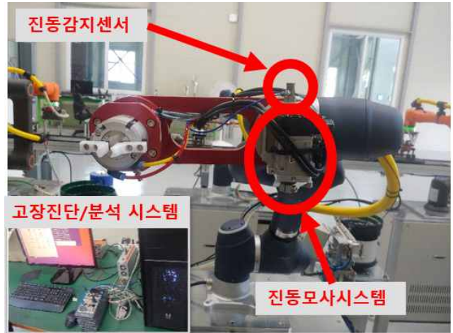
〈그림 1〉 고장진단 및 진동모사를 위한 시스템 구성
