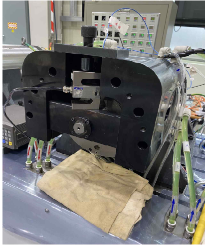
〈그림 2〉 하중 부가장치가 설치된 스핀들모터
