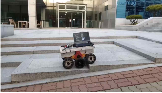
<그림 2> 실내외 자율 주행 로봇 단차 극복 테스트
