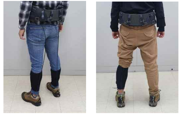
〈그림 5〉 의복 내/외부에 착용 가능한 보행보조용 착용로봇
