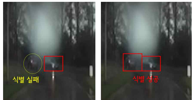
(a) 카메라 단독 (b) 카메라-레이더 융합 그림 3. 강우 상황에서의 표적 식별 결과
