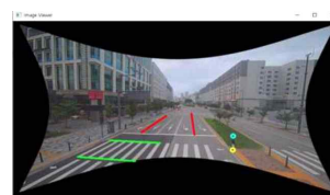
〈그림 3〉 카메라 calibration을 위해 두 개의 축에 대한 평행선을 입력한 경우
