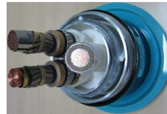
<그림 2> 2G-HTS케이블의 시료 사진
