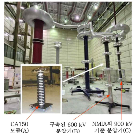
〈그림 1〉 직류 600 kV 분압기의 NMIA 교정
