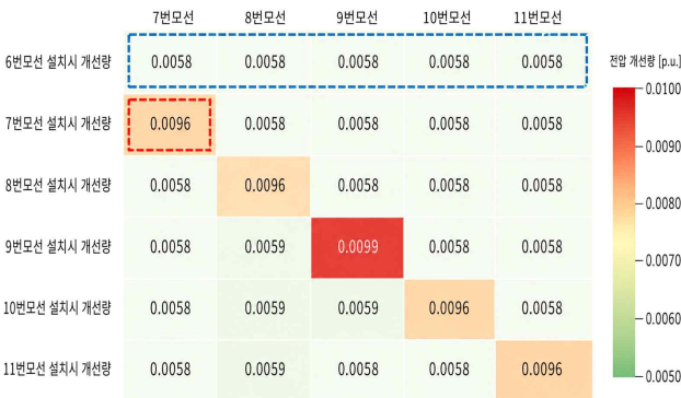
〈그림 3〉 병렬콘덴서 설치위치에 따른 전압 개선량
