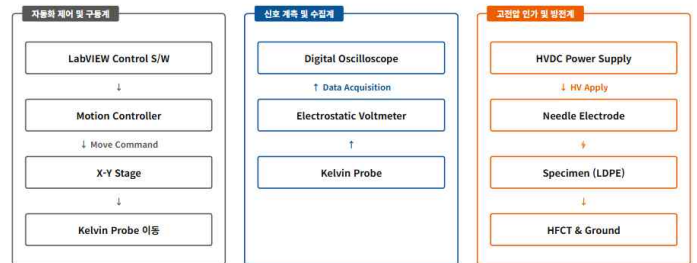
〈그림 2〉 표면 전위 측정 과정
